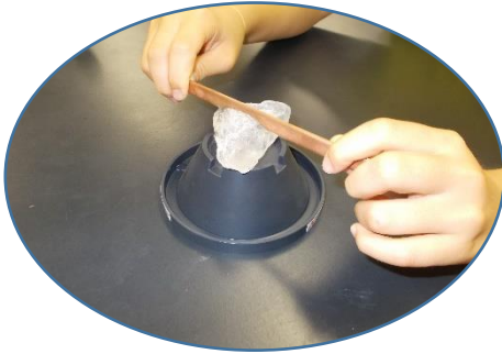
【ヒートパイプを使って氷を切る実験】
